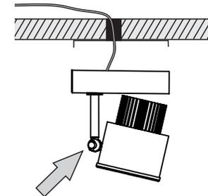
Encaixe o spot na base fixada ao teto
