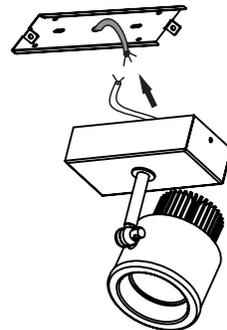
Com a rede elétrica desligada ligue os fios do driver aos fios da rede elétrica e isole com fita isolante anti chamas
