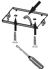
Aparafuse a chapa de fixação da luminária e passe os fios da rede elétrica
