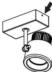
Solte os parafusos laterais para retirar a chapa de fixação da luminária
